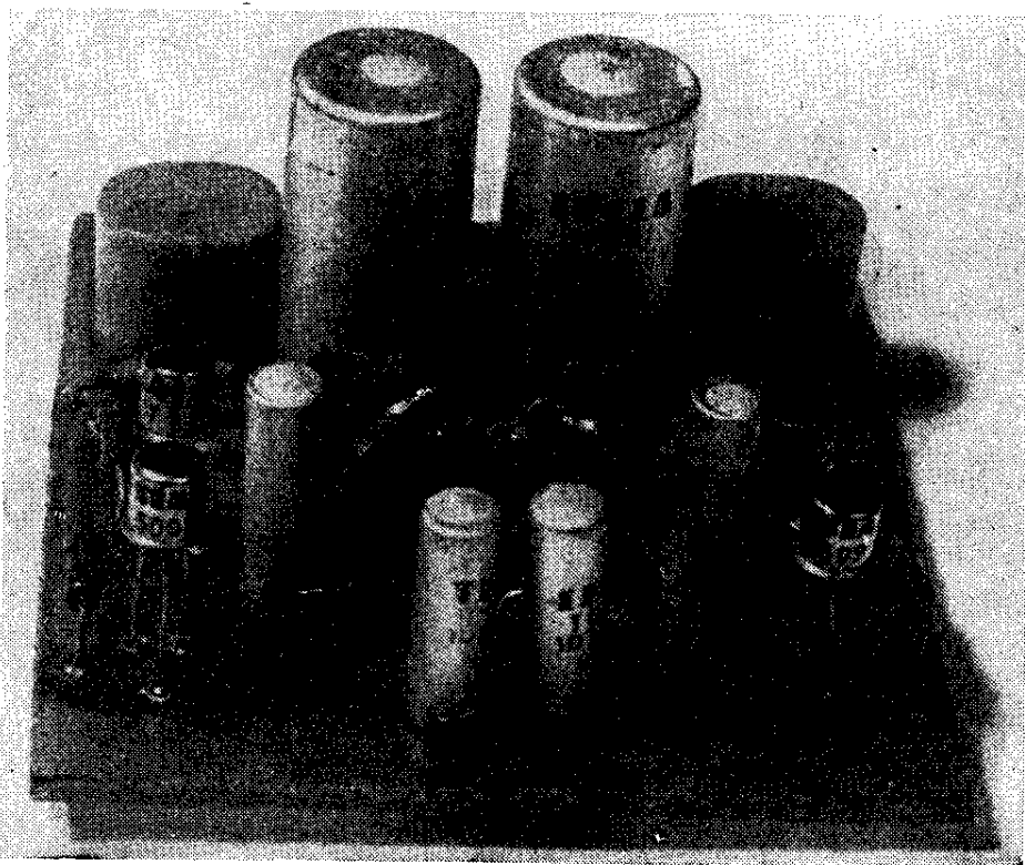
Obr. 67. Osazení destičky s plošnými spoji z obr. 66
