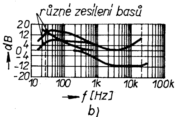
Obr. 25. Kmitočtové charakteristiky obvodu podle obr. 23c. Charakteristiky pro každý potenciometr v poloze maximum, střední křivka odpovídá všem potenciometrům v poloze minimum (a), typická křivka pro dva různé případy zdůraznění basů (b)
