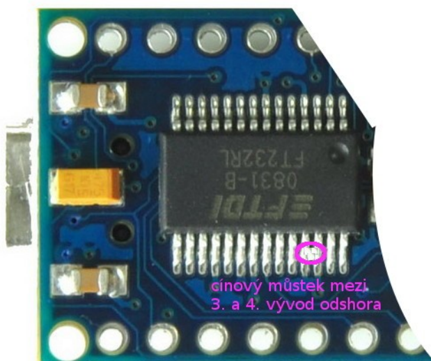
Obr. 3. Oprava Arduino Nano v. 3.0. Cínový můstek je mezi třetím a čtvrtým vývodem odshora.
